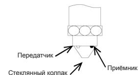
Отражательный эффект. В отсутствие воды инфракрасное излучение отражается от поверхности стеклянного колпака вовнутрь на фотоприёмник.
